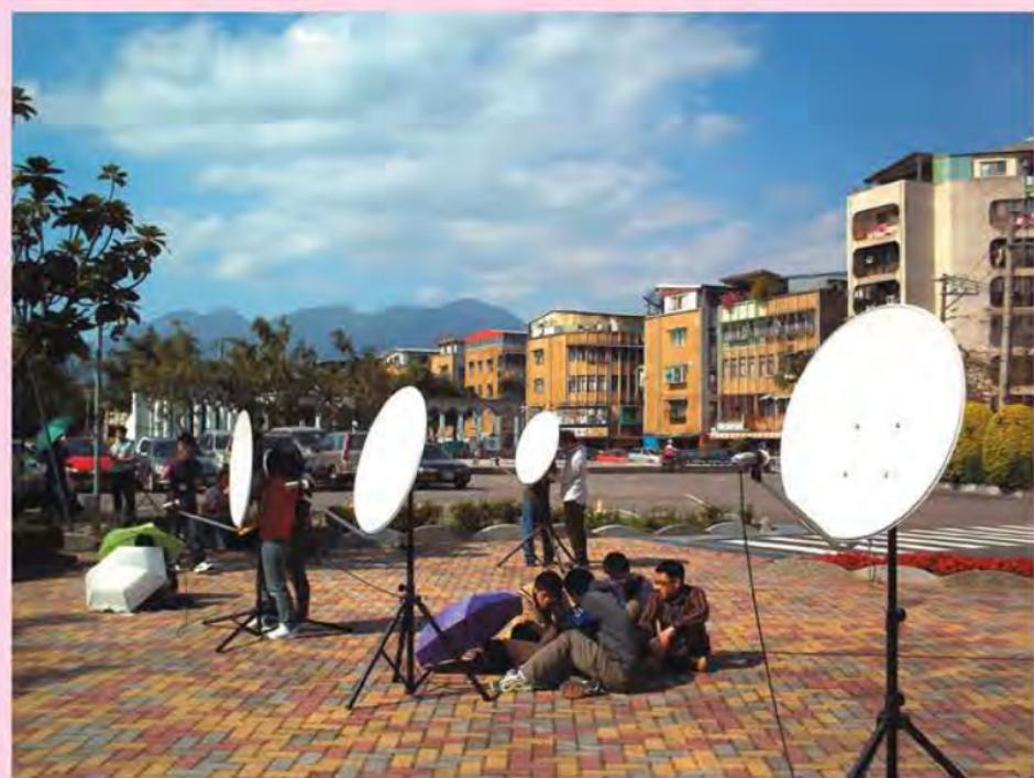
參與動手作活動的學生正在用自製80公分口徑的電波望遠鏡觀測太陽。
