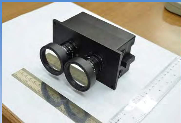
圖說：太空天文與電漿科學研究所與物理系、電漿與太空科學中心自主研發設計的「雙通道光學瞬變相機 Dual-band Optical Transient Camera, DOTCam」，將安裝在日本 RISEsat (Rapid International Scientific Experiment Satellite) 微衛星上，預計於 2013 年發射升空，進行大氣電學與流星的科學研究。©成功大學太空天文與電漿科學研究所
