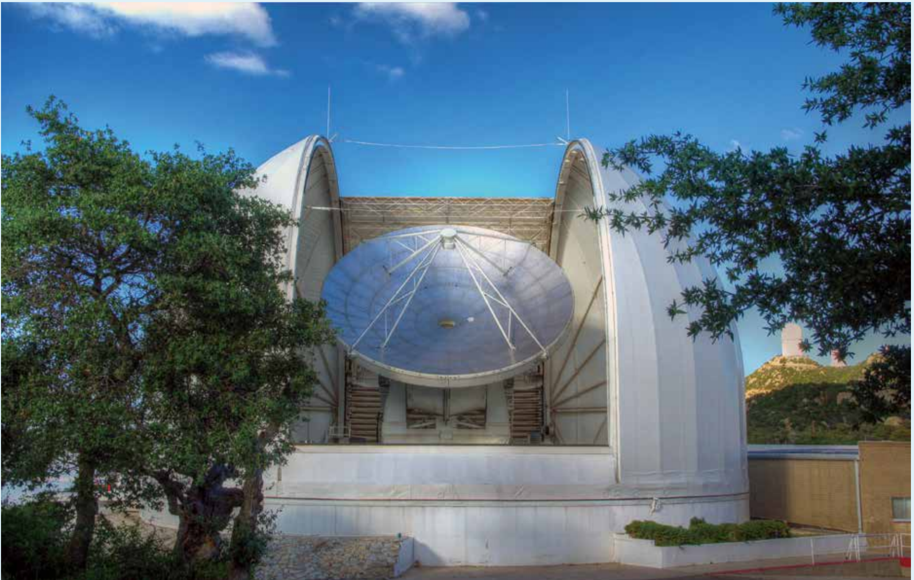
本所也有參與的 TIME 計畫，將使用位於美國亞利桑那州 Kitt Peak 的 12 米望遠鏡。照片中的天線原本是 ALMA 的其中一座原型機，2013 年底被搬移到 Kitt Peak，其精細的表面是進行次毫米波長觀測時的極佳工具。©Thomas Folkers
