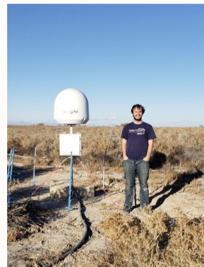
用來發現 FRB 的電波望遠鏡。位於美國的 STARE2 望遠鏡與研究生 Chris Bochenek。STARE2 觀測到銀河系中最強大的電波爆發。這種小型望遠鏡可以一次看到大部分的天空，但只能偵測到最明亮的爆發。©Chris Bochenek
