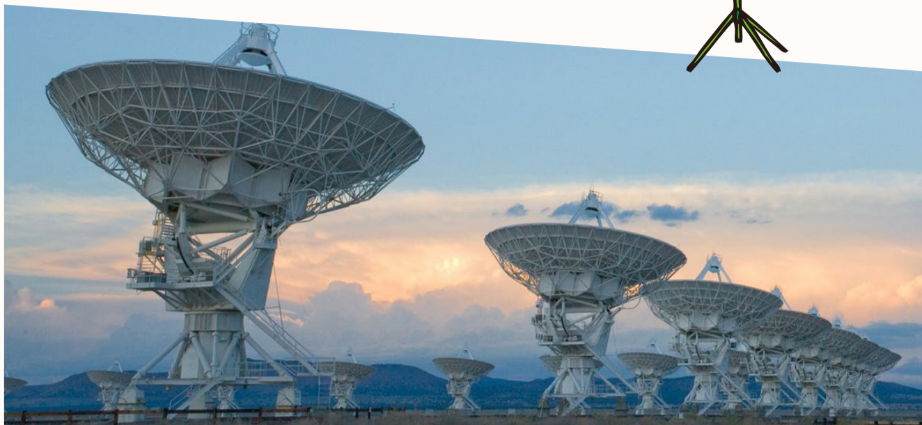
用來發現 FRB 的電波望遠鏡。位於美國的特大天線陣 VLA 有 27 個直徑 25 米長的碟形天線，彼此可以相距 35 公里。VLA 是用於繪製天空影像並將 FRB 定位到其宿主星系的強大工具。© Alex Savello
