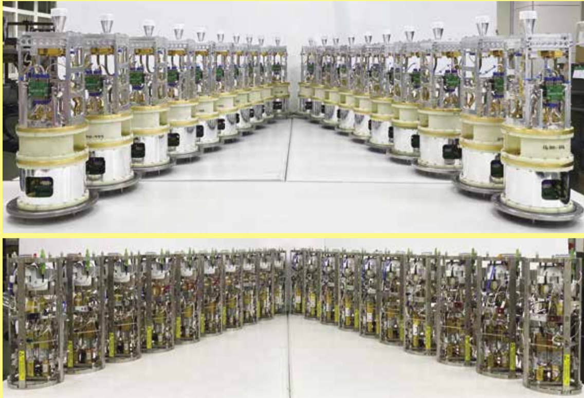
● 第一頻段接收機的低溫前級模組（上）和室溫前級模組（下）在臺灣中科院的實驗室進行組裝測試。 © 中研院天文所 / 中科院航空所
