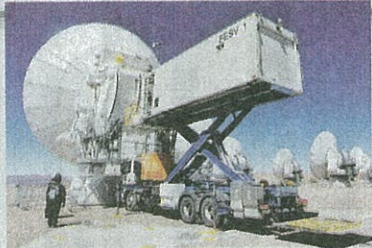
台灣製造兩輛負責維護天線接收器的「前段維護特種車」。(中研院提供)
