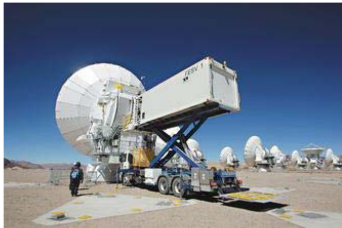
「在墾丁可看到台北101上的硬幣」台灣工業界及研究團隊主導製造ALMA兩台「前段維護特種車」，在海拔5000公尺高的山上替陣列做維護檢測。 圖／中研院天文所提供
