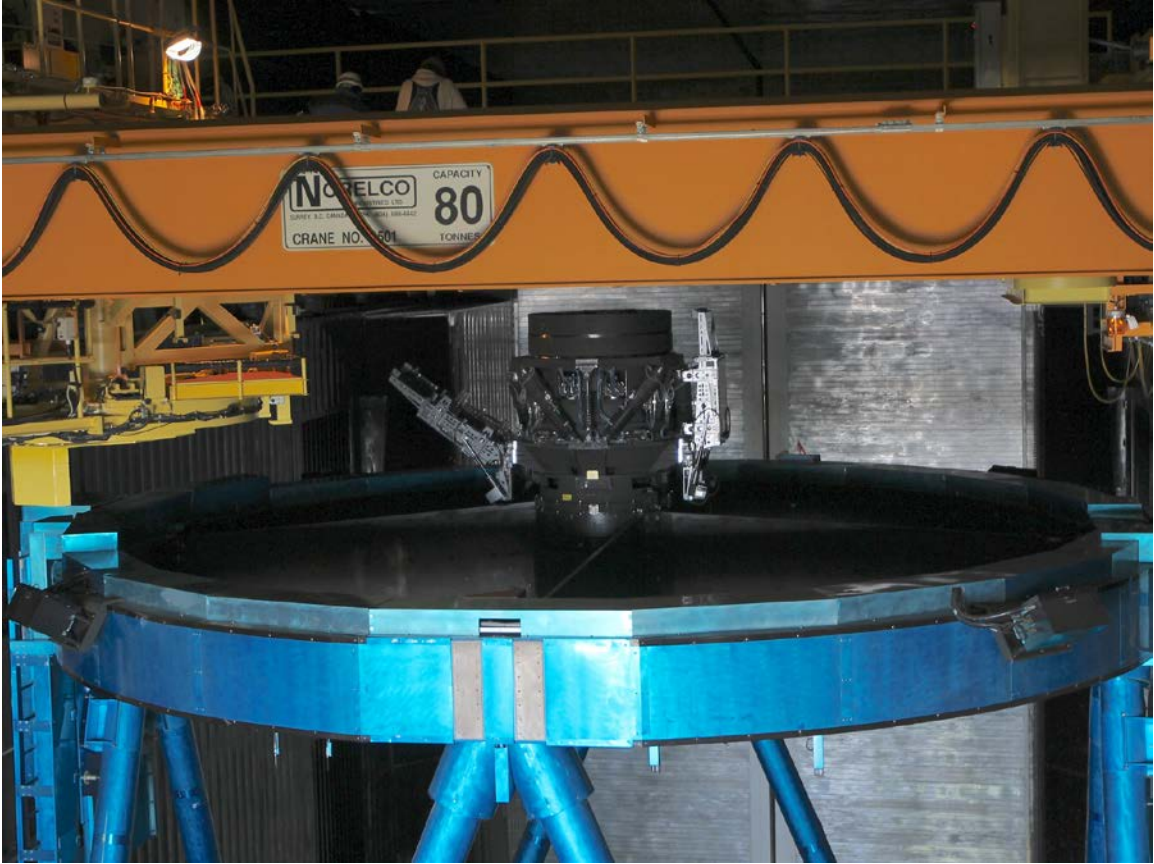
圖二：HSC 鏡頭的口徑是接近 90 公分，因此佔據了大部分望遠鏡主焦點的空間，FEU 必須利用有限的空間，將 60 公分大的濾鏡對準到光路中使其誤差小於 50 微米，也就是頭髮直徑的一半，在技術上是相當困難的。因此我們設計了精準的機械手臂來達成這個要求 (credit: NAOJ)。
