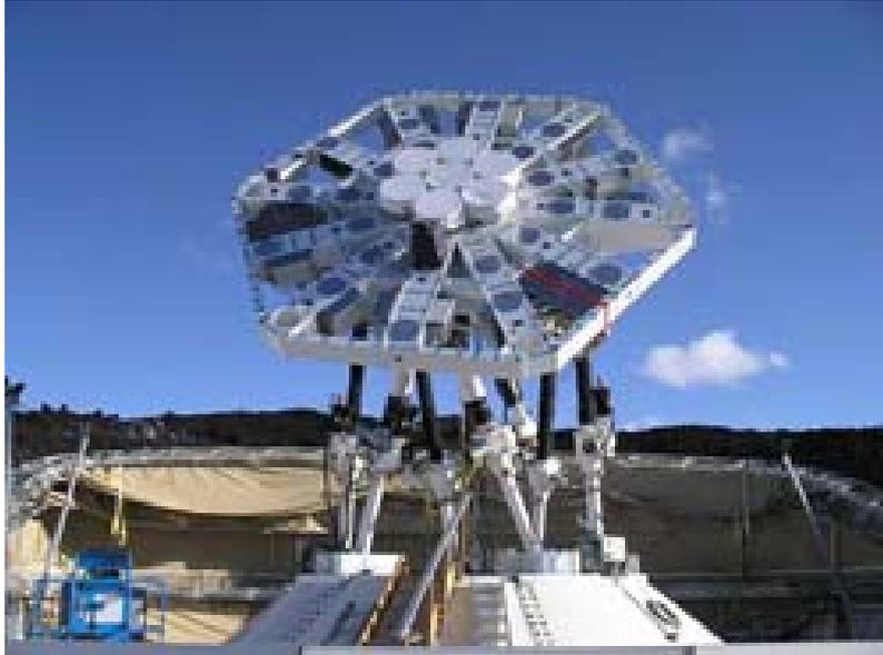
位於夏威夷毛納洛峰上的 AMiBA。照片中的 7 座 60 公分天線在 6 米的碳纖平台上構成最緊密的組態。天線外面套上防日曬的 GoreTex 罩。平台上還有光學望遠鏡、相關器、及相關的機械與電子元件。照片中亦能看見附於平台下的六腳螺桿系統。(圖片提供：中研院天文所；拍攝者: Patrick Koch)
